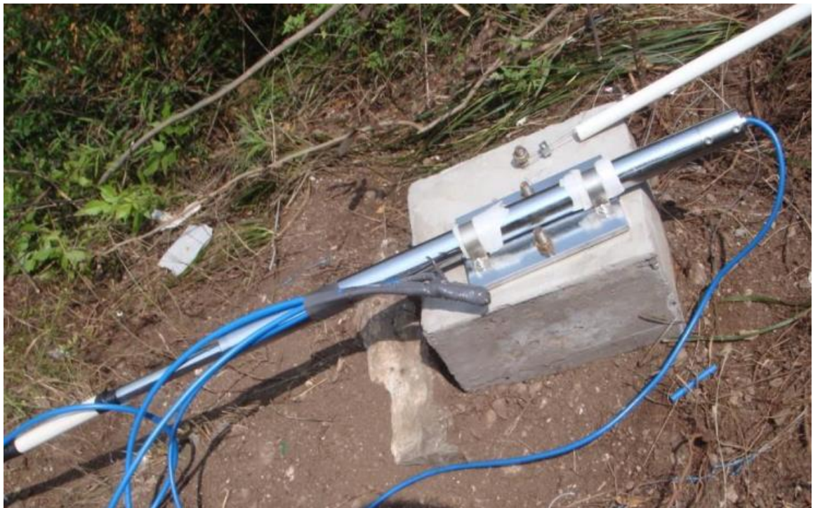
边坡位移计安装实例图
